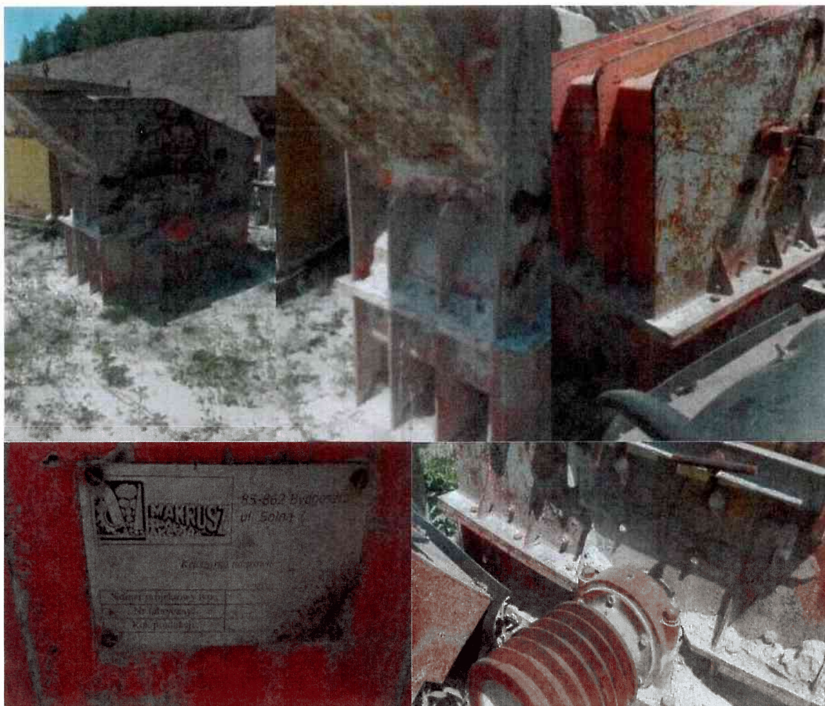
Kruszarka udarowa listwowa 40.76 produkcji Makrusz; rok budowy 2001
