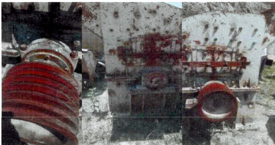
Kruszarka udarowa listwowa typ 40.76 produkcji Makrum; rok budowy 1993
